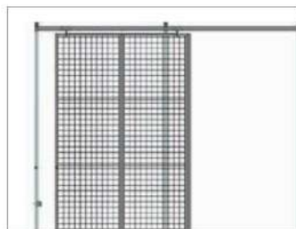
Barrière coulissante Hauteur standard 7' à 20' Largeur standard 3' à 20'
