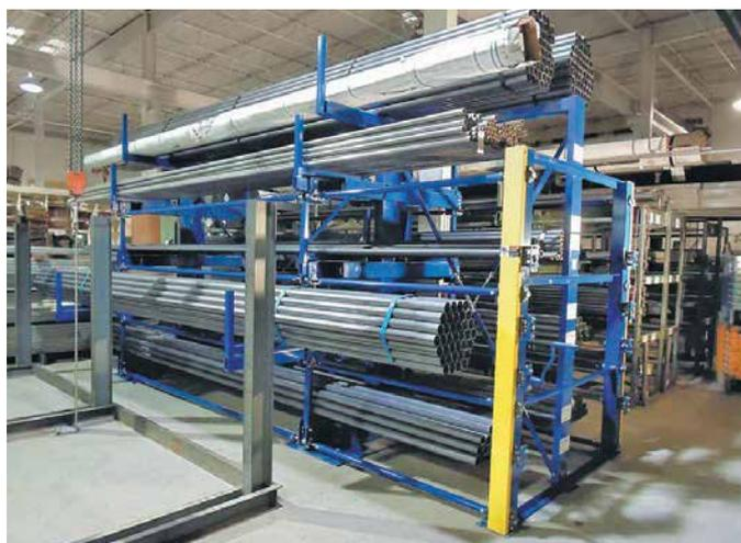
Excellent pour la manutention (barres, tubes, tuyaux, plaques d'acier, etc.). Ce type de palettier permet un accès par le haut. L'extension des bras (chargés à 100 %) se fait par un simple tour de manivelle.
