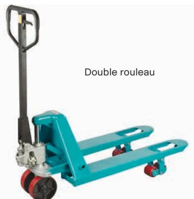
La fabrication solide de ces transpalettes en fait le meilleur rapport qualité/prix pour vos besoins en manutention. Commande manuelle à trois fonctions (soulever, neutre et abaisser) et poignée de sécurité annulaire à ressort et à redressement automatique qui augmentent le confort et facilitent le fonctionnement. Piston en chrome durci avec protecteur pour une performance fiable. Fini à revêtement de poudre durable.
