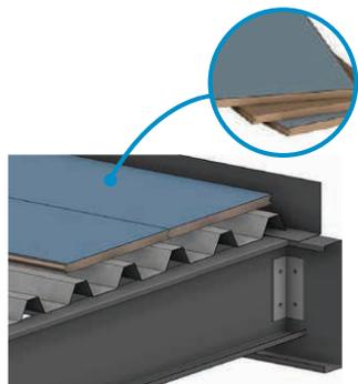
PANNEAU DE RÉSINE ET FINITION EN ACIER (sur pontage ondulé)
