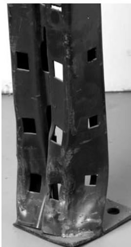
Figure 53. Montant endommagé: la soudure à la hauteur de la plaque de pied d'échelle a cédé
