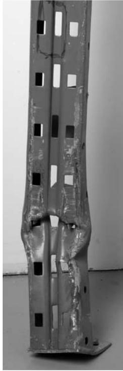
Figure 51a. Montant endommagé par des impacts répétitifs dans le sens latéral et frontal (Vue de face)
