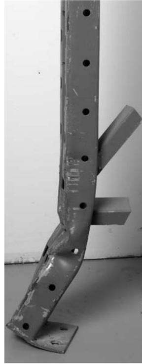
Figure 51b. Même montant endommagé (Vue de côté)
