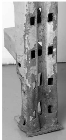
Figure 55. Montant en acier corrodé, usé par frottement et ressoudé
