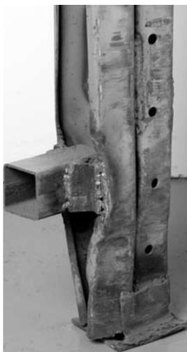
Figure 54. Montant double endommagé: soudure non conforme, usure et déformation du montant causées par le frottement des longerons du chariot élévateur
