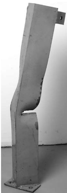
Figure 56. Protecteur de montant endommagé
