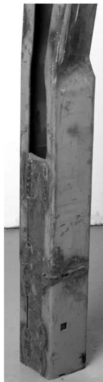
Figure 57. Montant endommagé et réparé par une soudure à l'électrode
