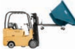
Pour faciliter le déchargement, le conteneur bascule vers l'avant lorsque le loquet est levé
