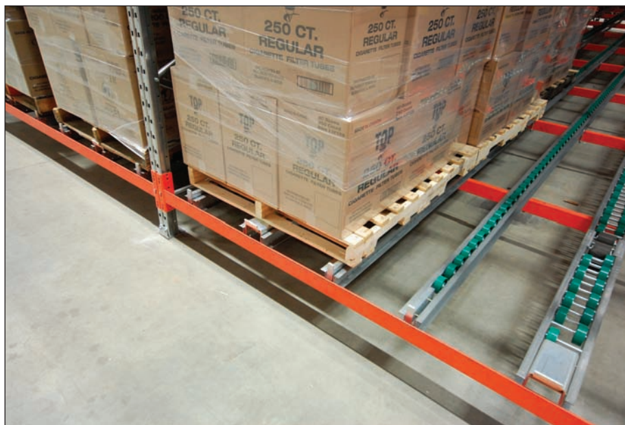
Une palette mesure quatre pieds de largeur et une rangée de palettier à gravité peut contenir 12 palettes. Deux rangées permettent de remplir une remorque de camion de 53 pieds.
