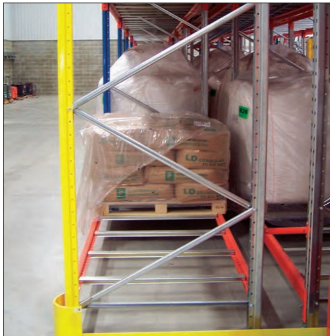
Quadra s'est dotée de paletiers avec boulons plutôt que soudés parce qu'ils sont plus forts, plus évolutifs, modifiables selon le type de marchandises placées sur leurs tablettes, démontables et plus faciles à transporter.
