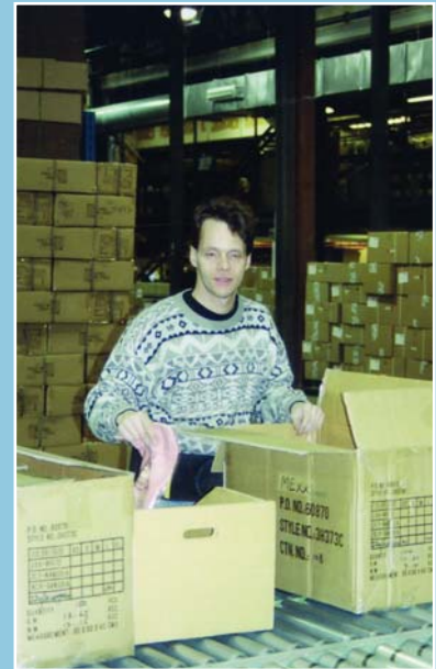
Les produits sont tout d'abord séparés par style, couleur et grandeur par une personne attirée à cette tâche sur le convoyeur dont les premiers pieds ne sont pas motorisés.
