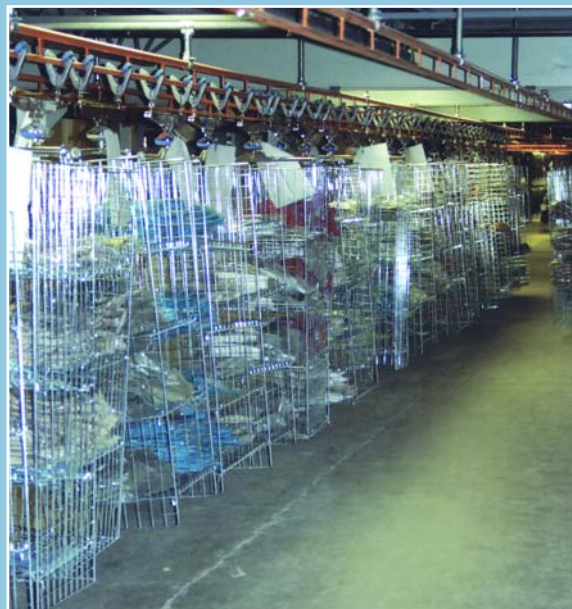
Le centre est maintenant doté du système VEIT, une conception allemande qui est bidirectionnelle et flexible pour les vêtements sur cintres.
